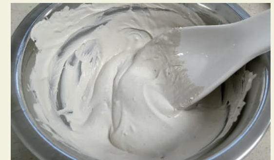
2.Primal® AC 35と白亜を混練する Mix Primal® AC 35 and chalk together and stir well
