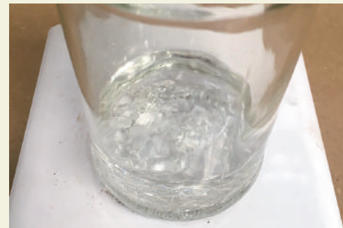
2. アセトンでParaloid™ B 72を溶解する Dissolve Paraloid™ B 72 with acetone
